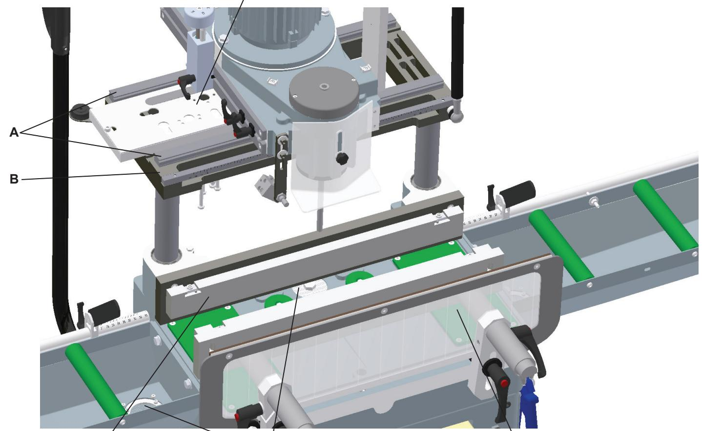
La caractéristique la plus importante du blocage est représentée par des contre étaux dédiés qui fixent le profilé au plan de travail sans aucune vibration. Le changement des contre étaux est très rapide grâce au système easy reverse.
