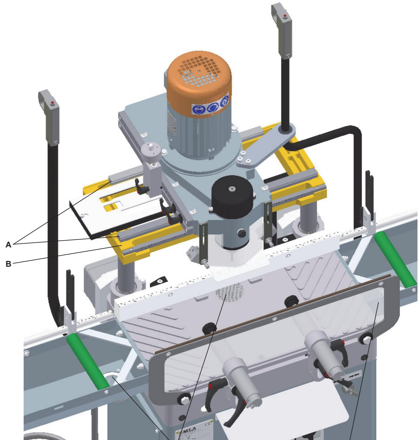
Les guidages linéaires (A, axes x et y) fixés sur le robuste support en fonte (B), permettent un travail très stable et sans vibration.
