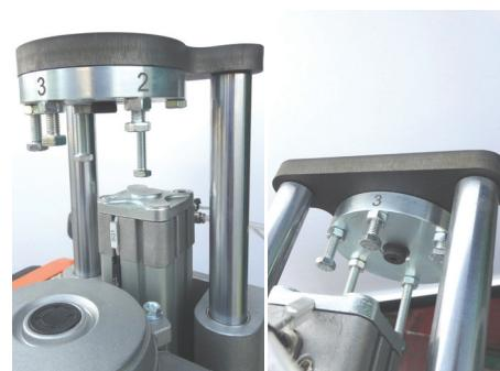
Der Vorlauf- und Bohrhub aller Einheiten beträgt 50mm und kann durch einen leicht-gängigen 6fach-Revolver einfach reguliert werden.
