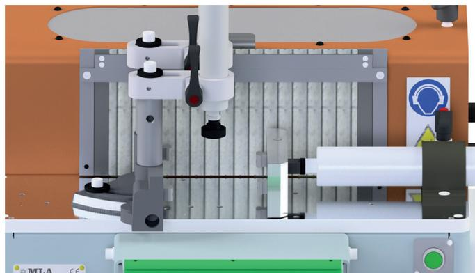
Una prensa horizontal opcional (código 502507) permite bloquear el perfil en ángulos de 45° a 135°. Este bloqueo incluye cuatro tuercas en "T" que actúan como guía y tope vertical para los contramoldes, que se pueden insertar y reemplazar en pocos segundos.
