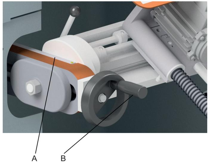
Las unidades se colocan con fluidez y precisión gracias a las grandes bielas (B) que, a través de tornillos trapezoidales (A), hacen que los carros se deslicen sobre guías en forma de L. Tanto las guías como los carros están hechos de fundiciones fuertes de hierro fundido.
