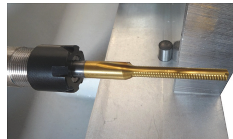
Opcional: Brocas Hss con recubrimiento de TiN + 8% Co con baja emisión de sonido a altas frecuencias y larga vida.
