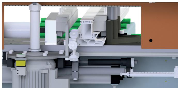
Sur la **M300** il est possible de régler soit le début (en plaçant le moteur à côté du profilé) soit la fin du fraisage (avec le micro-interrupteur de fin de course).
