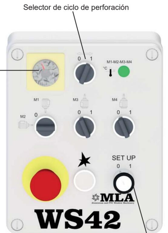
Antes de pasar a la fase de mecanizado es posible simular con la función "**Set-Up**" los movimientos de las unidades individuales, sin encender los motores.
