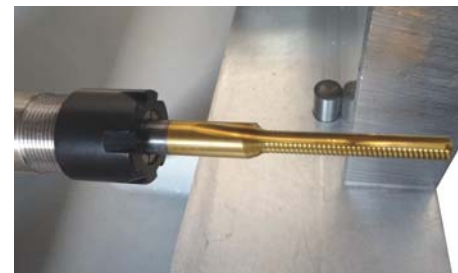
Optionnel: fraises en Hss+8%Co avec couche de AlTiN, réduite émission de bruit aux hautes fréquences et longue durée.
