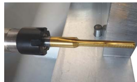
Optional: HSS+8%Co-Fräser mit AlTiN Beschichtung reduziert Geräuschabstrahlung bei Hochfrequenz und langer Bearbeitungsdauer.
